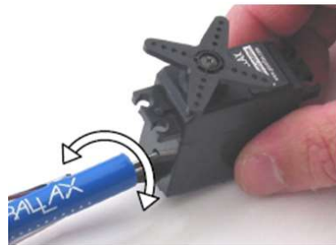
그림4.4 : 서보모터 중심맞추기를 위해 스크류를 조정하는 방법 (출처: parallax.com)
